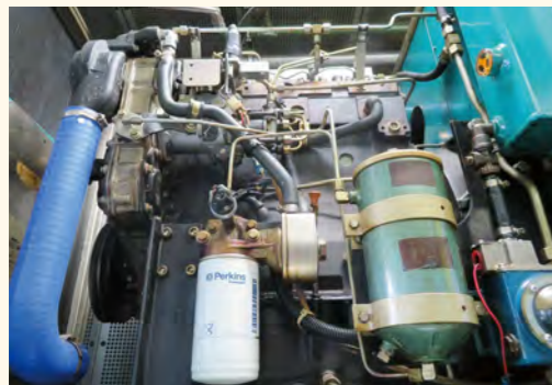
バイオガスとバイオディーゼル燃料で発電する30kWデュアル燃料発電機
