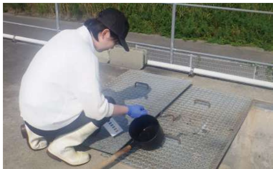
放流水のBOD（生物化学的酸素要求量）測定
