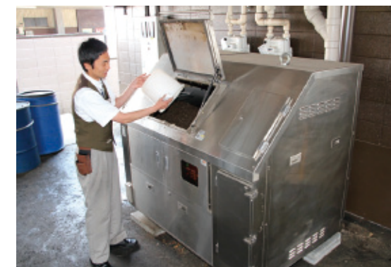
店舗に設置されている生ごみ粉碎乾燥処理機「ゼロワンダー」。生ごみの減容と一次発酵処理を行い、生ごみ資材を作ります。
